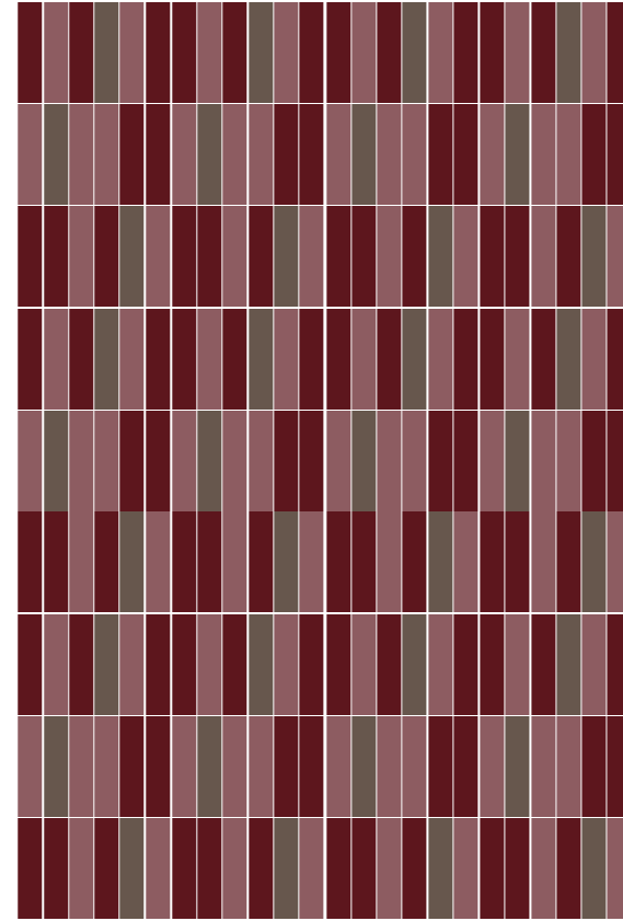
Schema di posa Laying scheme
